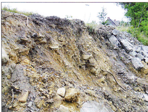
Skarpa główna osuwiska. (Fot. 3, Z. Zimnal, 2018-07-26).
